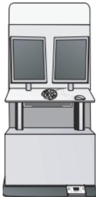
**Estação de trabalho de aquisição Mammomat Fusion: console de controle com protetor contra radiação (opcional), PC, monitor de tela plano, teclado, mouse, teclado numérico**
